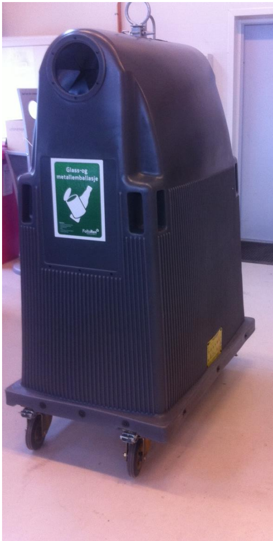
Plastcontainer for glass- og metallemballasje på 770 liter. Tømmes med kranbil rett i stor stålcontainer på lik måte som glasscontainerne på returpunktene.
