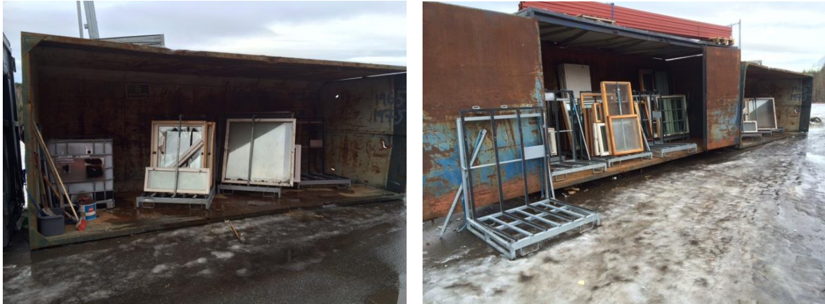
Lagringsplass hos Follo Ren IKS for lovpålagt «under tak» løsning for vinduer med PCB- eller klorparafiner og for EE-avfall
